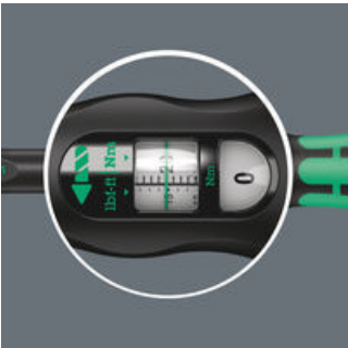
El valor del par de apriete deseado se puede ajustar y asegurar de manera muy fácil; para la lectura del valor se dispone tanto de una escala principal como de una escala fina.
